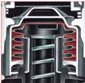
■ Конструкция сиффона в разрезе
